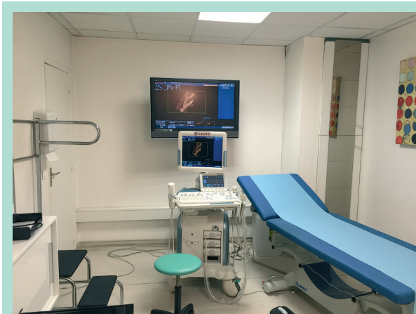
FIGURE 2 : Cabinet de phlébologie équipé en appareil d'écho-Doppler 3D relié à un écran répéteur haute définition (HD).
