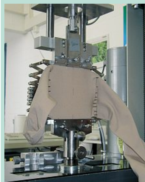
FIGURE 8 : Dynamomètre, instrument permettant d'obtenir la courbe caractéristique des matériaux force = f(\text{allongement}) .
