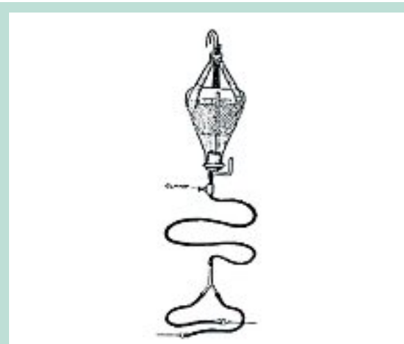
FIGURE 4 : Remplissage par gravité ressemblant au système « pieuvre ».
