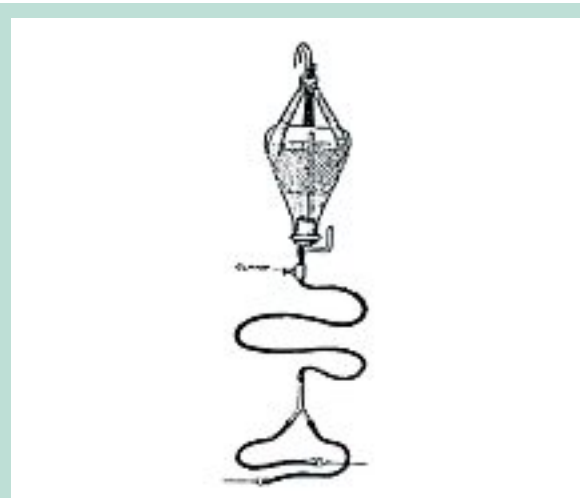
FIGURE 4 : Remplissage par gravité ressemblant au système « pieuvre ».
