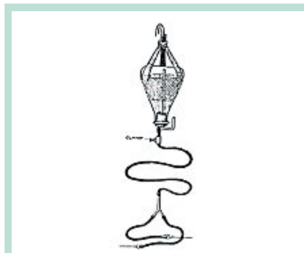
FIGURE 4 : Remplissage par gravité ressemblant au système « pieuvre ».
