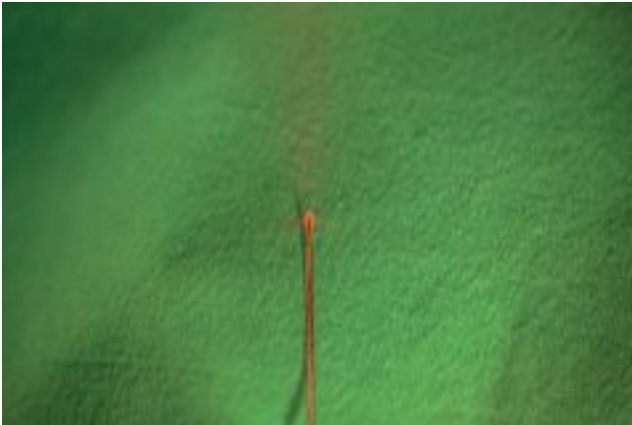
Photo 1. – Extrémité de la fibre laser et de sa gaine
