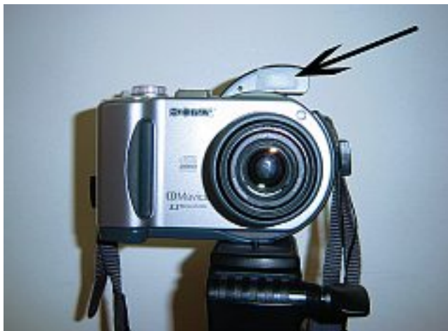
Fig. 1. – Appareil Sony Mavica utilisé avec l'atténuation du flash
