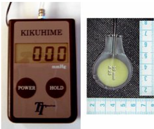
Photo 1. – Système de mesure Kikuhime®
