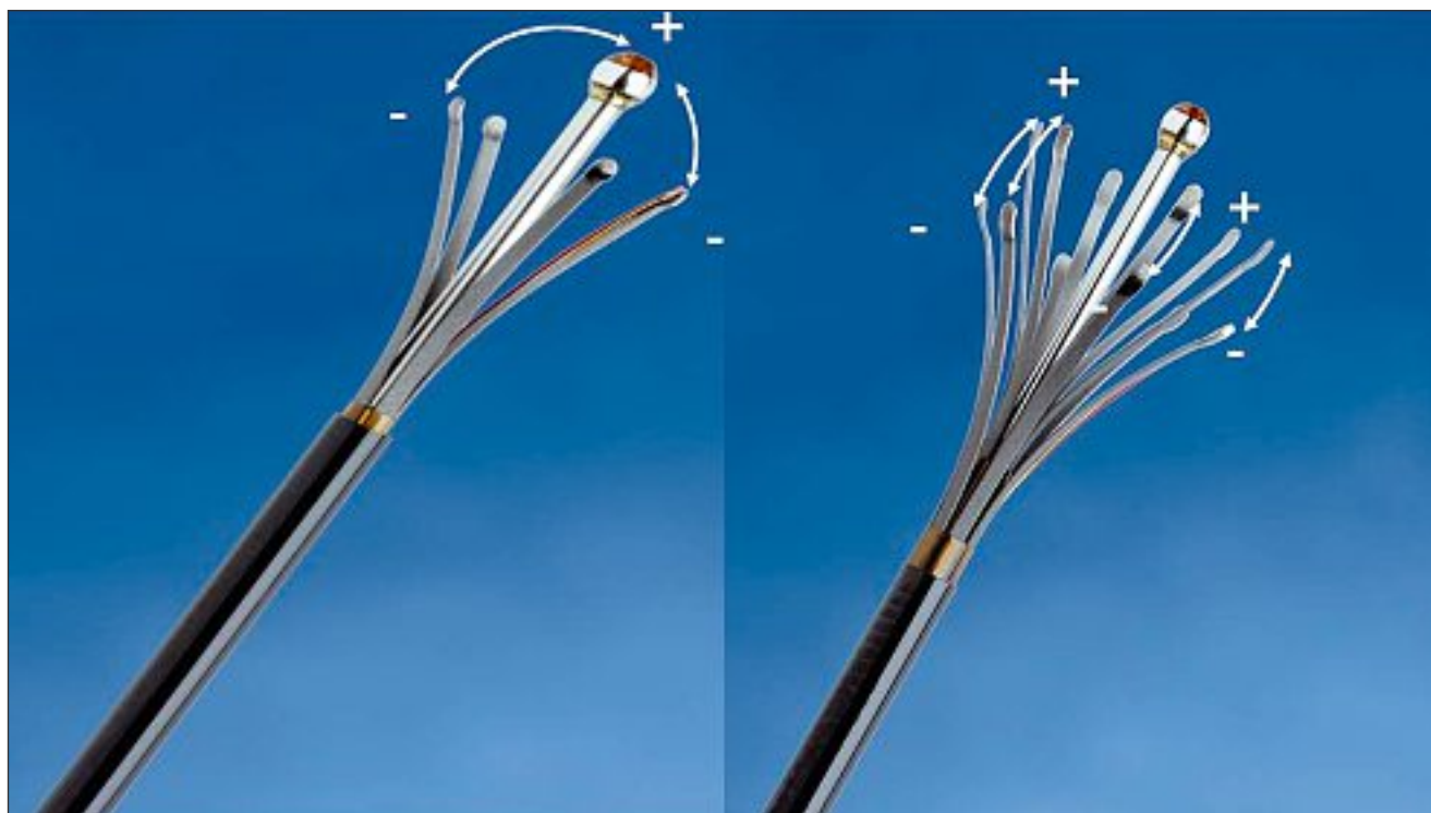
Photo 1. – Concernant le cathéter ClosurePlus® l'élévation thermique s'effectue sur la hauteur d'un disque circulaire de 3 mm de hauteur entre les 2 pôles + et - des électrodes appliquées sur la paroi veineuse
