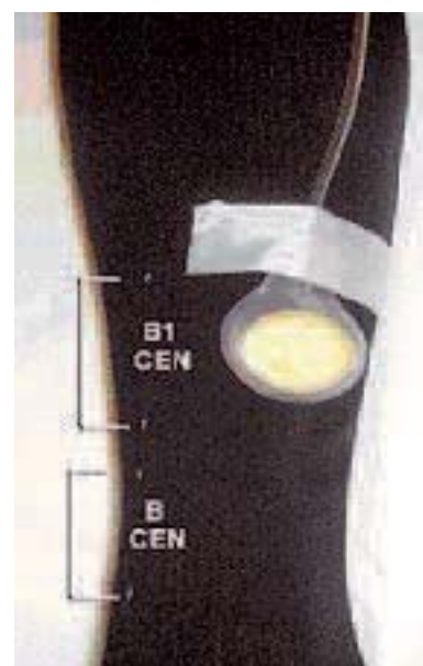
FIGURE 3 : Marquage des chaussettes au point B1 CEN. (les marques correspondent aux points de mesures dynamométriques in vitro : B en bas et B1 en haut.
