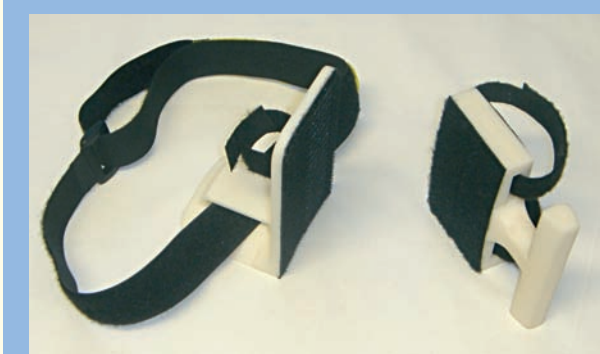
FIGURE 1 : Dispositif porte-sonde échographique ultrasonore.
