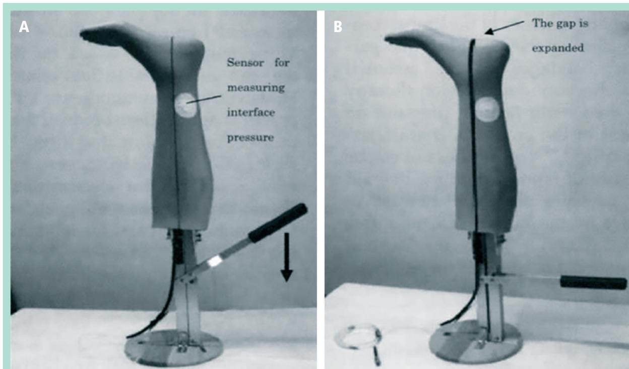
**FIGURE 1 :** Système de mesure de la rigidité. La jambe en plastique d'Hiraï a été coupée frontalement en 2 parties (A) et l'espace peut être élargi de 5 mm en abaissant un levier (B), ce qui augmente la circonférence de 10 mm.
