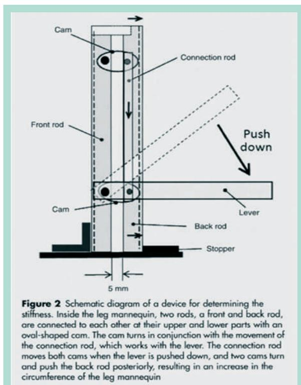
**FIGURE 2 :** Schéma du principe de la jambe Hirai.
