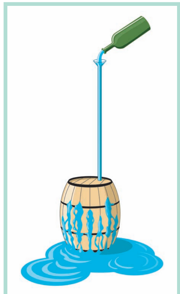
FIGURE 3 : La célèbre expérience du tonneau de Pascal montre l'effet de la poussée hydrostatique.
