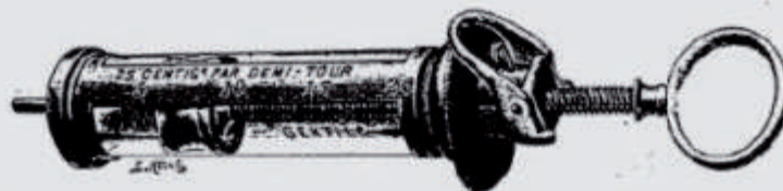
Seringue du Dr. Olivier de 1895. Elle a une contenance de 20ml, et possède un système permettant de débrayer le pas de vis et de transformer le mouvement rotatif en une translation continue (facilitant le remplissage de la seringue). Extrait de : « Nouvelles seringues ».[117]
